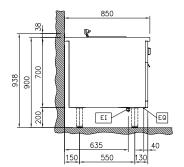
Electrical inlet (power) Equipotential screw
